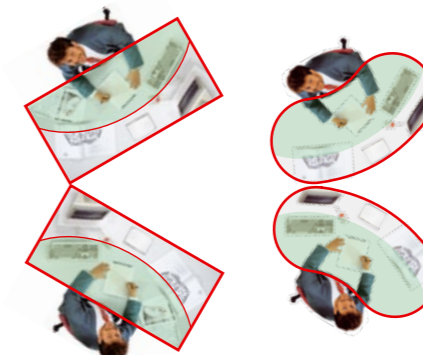
Der Flächenbedarf bei schräg platzierten Schreibtischen im Vergleich mit geraden Tischplatten (links) und runden Vital-Office Tischformen (rechts)
